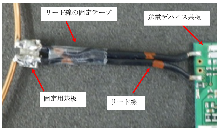
図 7. 送電コイルの取付け例
